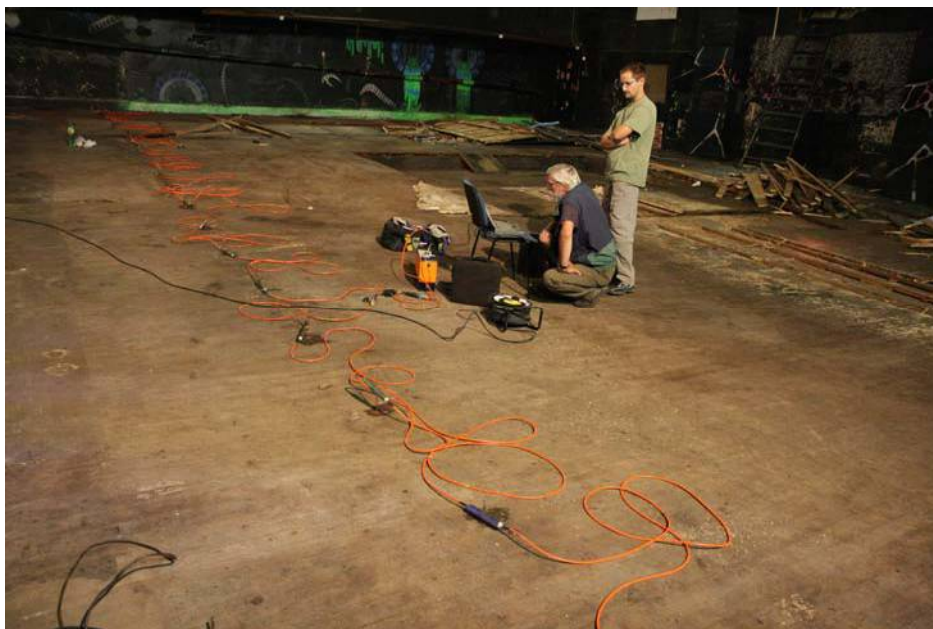
Obr. 4: Fixace elektrod při měření metodou odporové tomografie. Tenké měděné elektrody jsou vkládány do vývrtů v betonové podlaze. Elektrody jsou pak vzájemně propojeny a spojeny s přístrojem.
