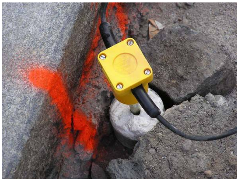
Obr. 3: Fixace seismického snímače (geofonu) do sádrového válečku
