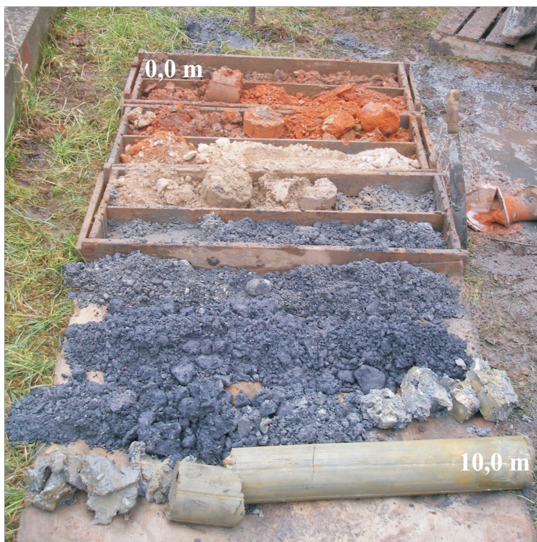
Foto č. 4: Vrtné jádro nevystrojeného vrtu MNV-3 situovaného u vrtu SM-9 (hloubka 0,0 - 10,0 m p.t.)
