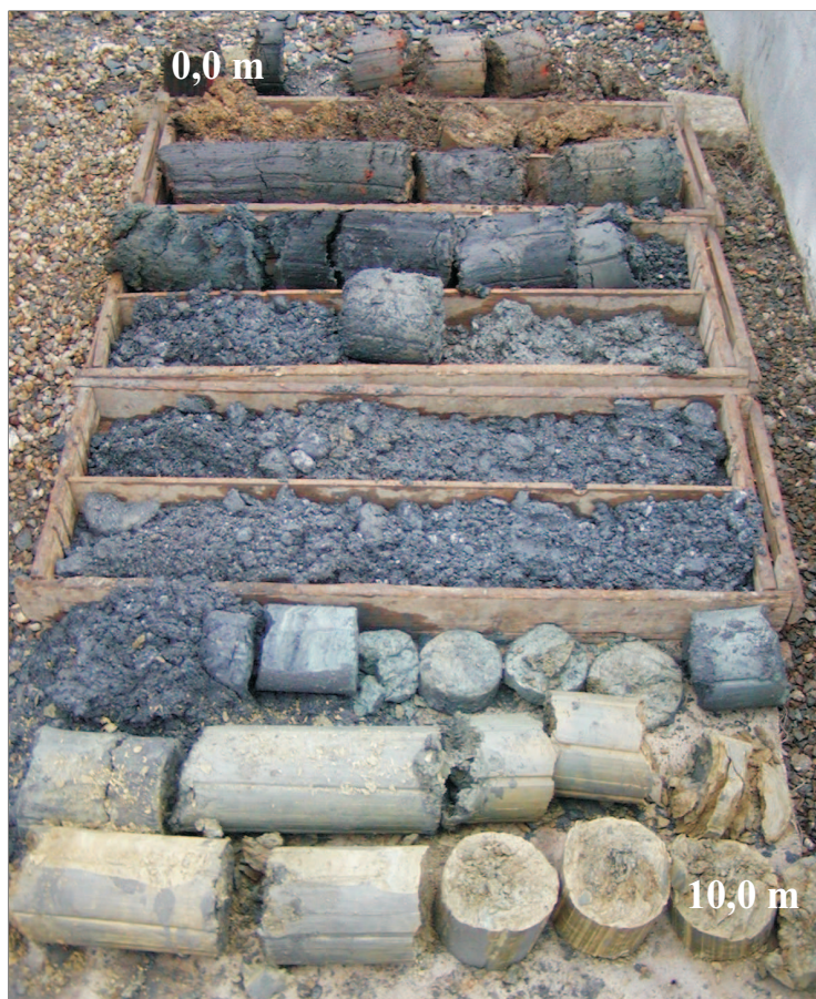
Foto č. 3: Vrtné jádro nevystrojeného vrtu MNV-1 situovaného u FAR-10 (hloubka 0,0 - 10,0 m p.t.)
