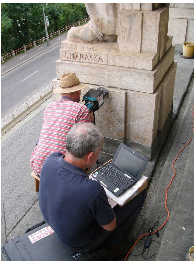
Měření poškození kamene metodou odporového vrtání
