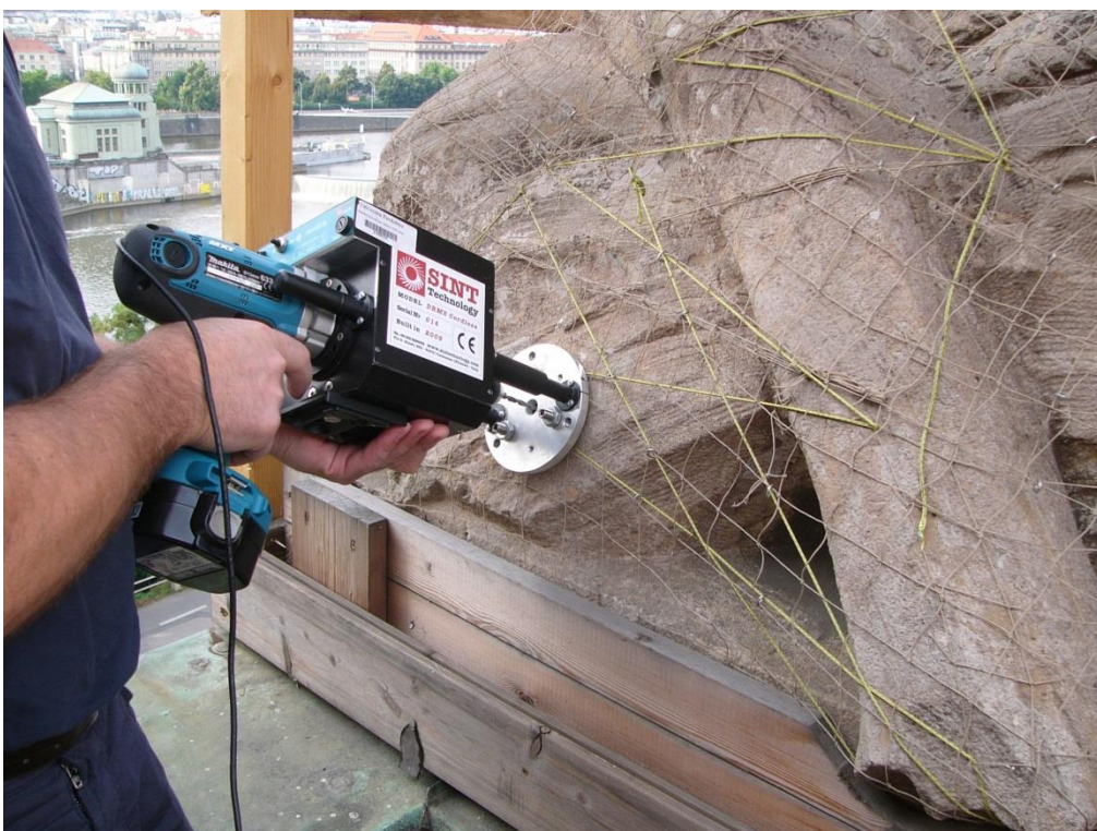
Měření poškození kamene metodou odporového vrtání
