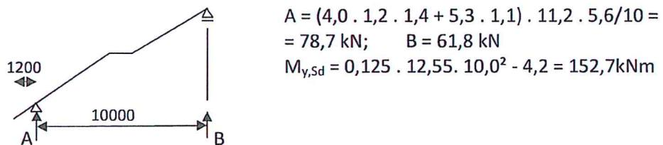
Profil P30x320:  $A = 9,60 \cdot 10^3 \text{ mm}^2; J_y = 81,92 \cdot 10^6 \text{ mm}^4; W_y = 512 \cdot 10^3 \text{ mm}^3$
