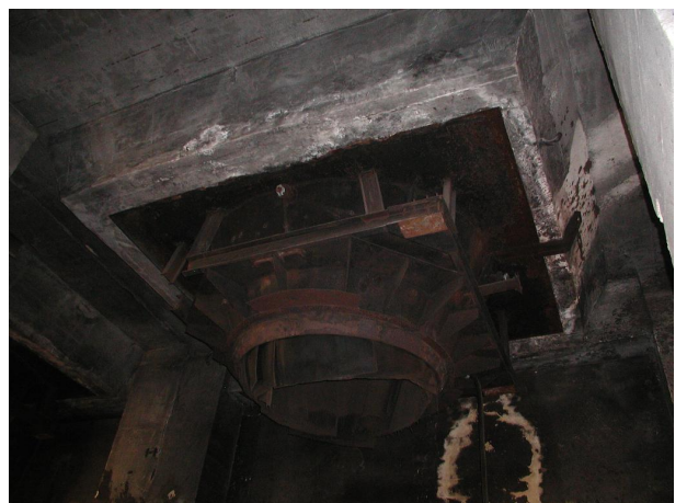
výsypka směšovacího zásobníku
